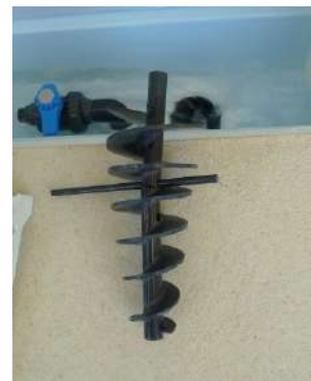
Figure 7 : Exemple de tourbillon anti-bruit à placer dans les chutes de goulottes
